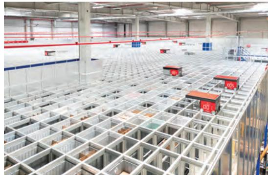
Grille de l'AutoStore avec 140 000 emplacements hébergeant 64 000 bacs de stockage divisibles alimentés par 14 robots autonomes.
